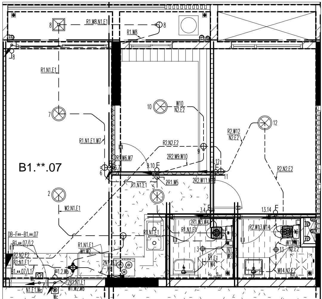
MẶT BẰNG KÉO DÂY CHIỀU SÁNG CĂN HỘ B1.(03:21).07
