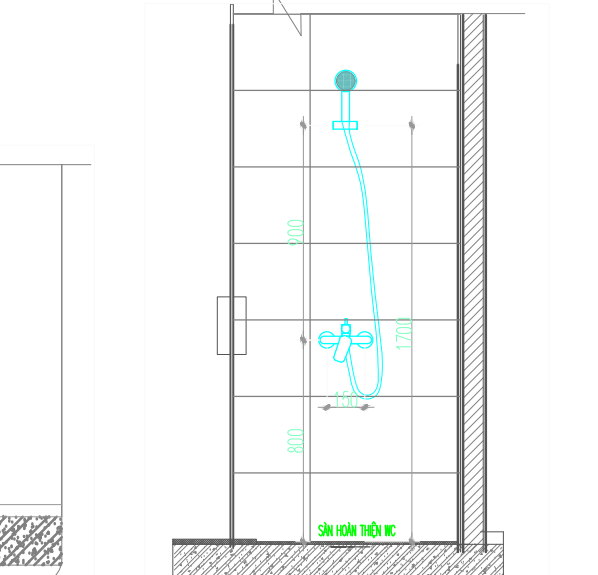
CHỈ TIẾT LẮP ĐẶT CẤP NƯỚC KẾT
