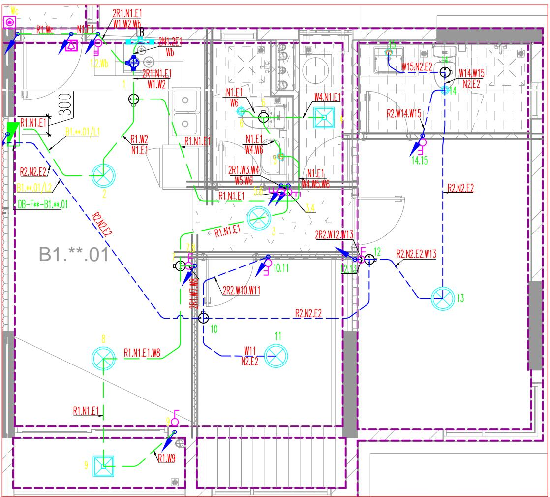
MẶT BẰNG KÉO DÂY CHIỀU SÁNG CĂN HỘ B1.(03:21).01
